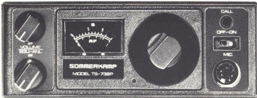
TS - 732 P 5 W - 32 canali - 11 - 16 Vcc e 110/220 Vca
